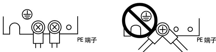
(c)使用漏电断路器时，为防止触电，必须将伺服放大器的保护端子接地。
